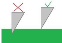
La découpe à l'emporte pièce oblige un contact entre la lame et le billot. Veillez à limiter la profondeur de pénétration de la lame dans le billot. Une découpe nette n'est pas forcément associée à une forte pression, un réglage fin est obligatoire pour une découpe propre et une usure maitrisée du billot.
