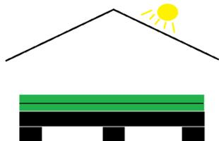
Veillez retirer tout emballage du billot. Veillez à le stocker à plat sur une palette s'il n'est pas monté directement sur la presse. Protéger les billots des hautes températures provenant du chauffage ou du soleil. Les billots sont fait en thermoplastique, un stockage à des températures élevé et sur un support non plat peuvent créer une déformation de celui-ci.
